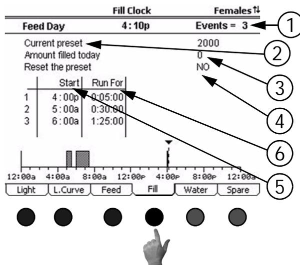
Figure 27. Clocks Screen: Fill Tab
