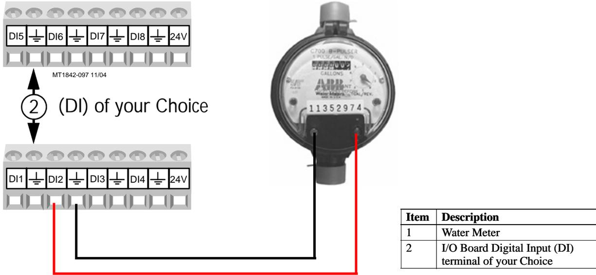
Figure 95. Water Meter Wiring
